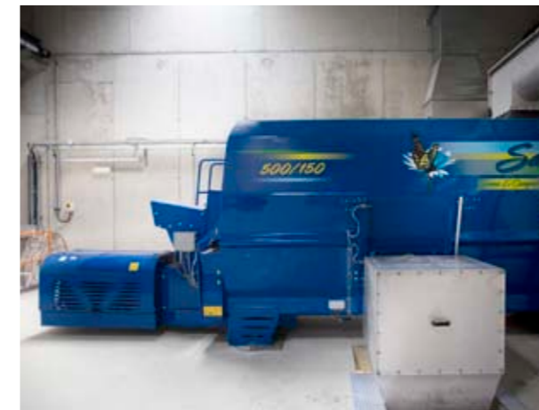
Das Mischverhältnis von Strukturmaterial und Gärrest ist ca. 1:1 The mixing ratio of structure material and fermentation residue is ca. 1:1
