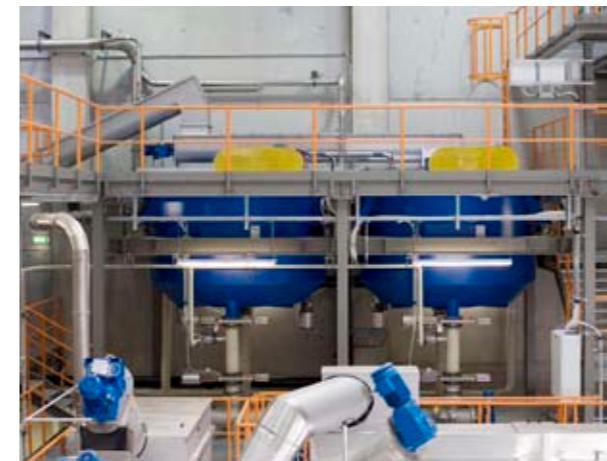
Die TURBOMIXER haben ein Nutzvolumen von je 10 m 3 The TURBOMIXERS have a usable volume of 10 m 3 each
