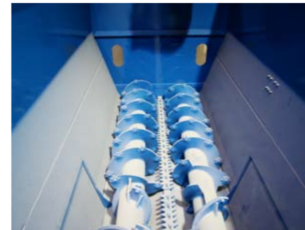
MISCHAGGREGAT mit 2 gegenläufigen Schnecken MIXING AGGREGATE with two counter rotating screws
