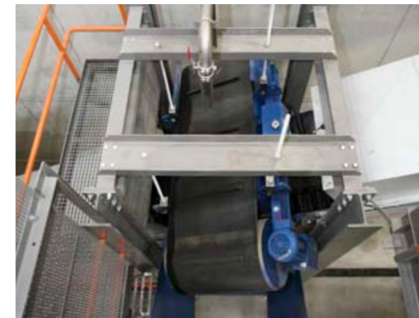
Ein MAGNETABSCHIEDER separiert die Eisen-Metalle aus dem Abfall A MAGNETIC SEPARATOR separates the ferrous metals from the waste
