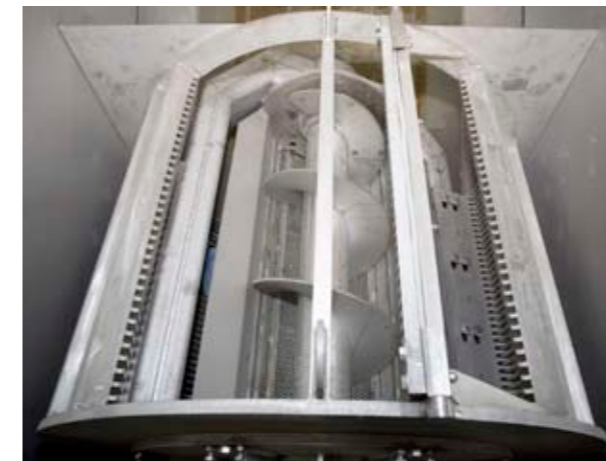
RECHENKORB mit umlaufender Harke RAKE CAGE with a revolving rake
